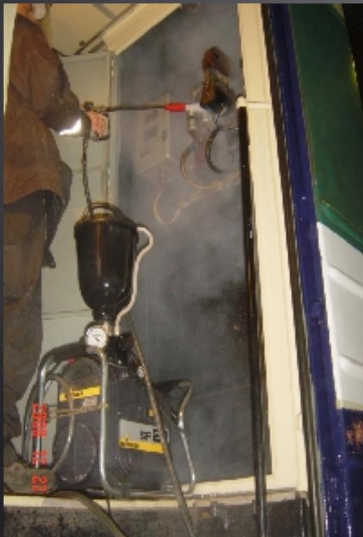
ПРЕДВАРИТЕЛЬНАЯ ОБРАБОТКА СОСТАВОМ **FIXEL CC (CONCENTRATED CLEANER)** ДЛЯ РАЗМЯГЧЕНИЯ СТАРОЙ СМАЗКИ. ВЫДЕРЖКА В ТЕЧЕНИЕ 10-20 МИНУТ.
